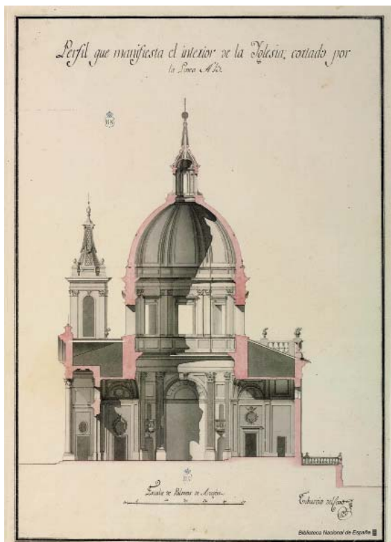
Fig. 5: Sección longitudinal de la iglesia de San Fernando en el Monte Torrero. c. 1793. Tiburcio del Caso delineó. BNE, Dib. 14-45-12.
